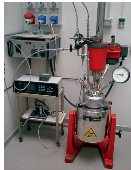
Reattore per la sintesi di omopolimeri e copolimeri in uso presso la sede milanese di ISMAC
